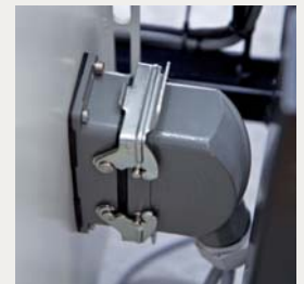
Schnellkopplung zum festen Abtrennen der Förderer
